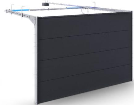
Die Positionierung der Federn am hinteren Träger ermöglicht den Einbau großer Türformate mit nur 120 mm Durchgangshöhe. Die Torsionsfedern sind für 25.000 Zyklen ausgelegt. Das INFINITI R-System ermöglicht ein Türgewicht von bis zu 165 kg.
