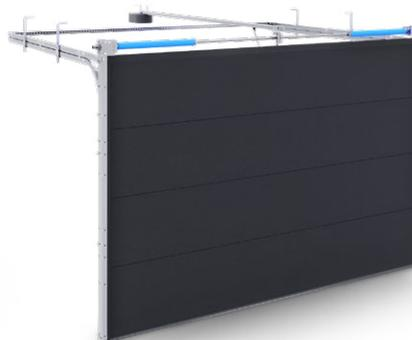
Die Positionierung der Torsionsfedern an der Vorderseite ermöglicht die Realisierung der größten Türformate, die eine minimale lichte Höhe von 200 mm erfordern. Die Torsionsfedern sind für 25.000 Zyklen ausgelegt. Das INFINITI F-System erlaubt ein Türgewicht von bis zu 290 kg.
